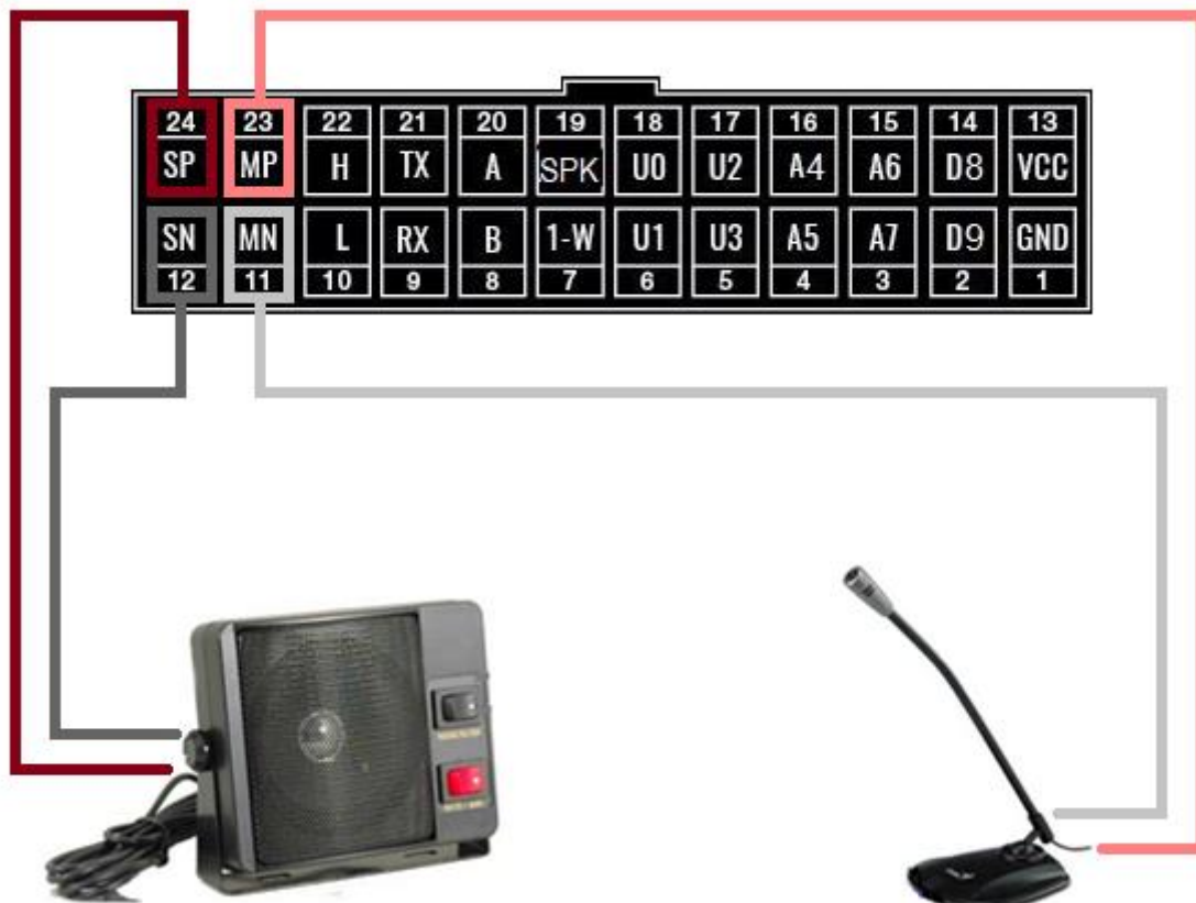
Рисунок 9 – Схема подключения микрофона и динамика
